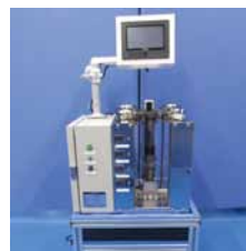
Oリング組付装置（手動） Manual type for external O-ring installation
